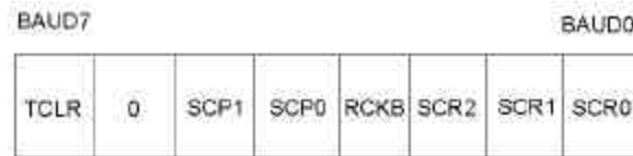
Figura 3.3: Registro de control de velocidad.
