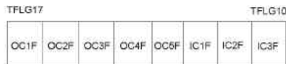
Figura 4.5: Registro de estado de comparadores y capturadores.
