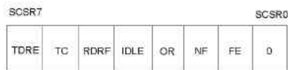
Figura 3.2: Registro de estado del SCI.
