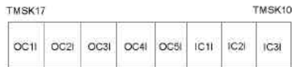
Figura 4.6: Registro de máscara de comparadores y capturadores.
