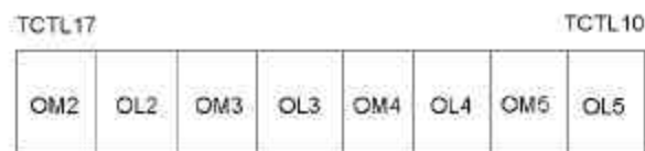
Figura 4.4: Registro de control de los comparadores.
